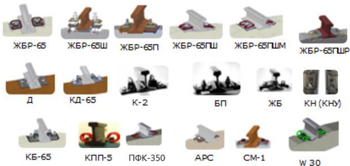
Рисунок 1.1 – Основные конструкции скреплений для Российских железных дорог
